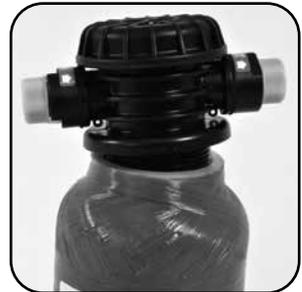
Filterkopf handfest auf Patrone aufschrauben. **Achtung!! Anschlussarmatur nicht verkanten. Dies kann das Innengewinde beschädigen. Achten Sie auf den korrekten Sitz des O-Rings!**
