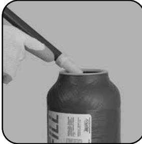
Filterkopf mit Steigrohr nach oben ziehen.
