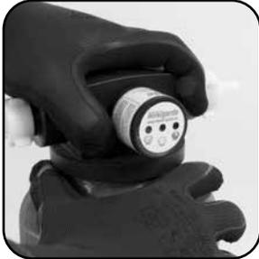
Wasserdruck aus Patrone ablassen und Filterkopf abschrauben.
