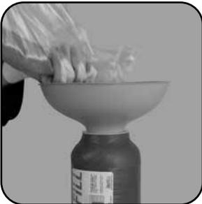
Setzen Sie den Trichter auf die leere Patrone und füllen Sie das neue Harz ein.
