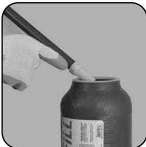
Nettoyez la résine sur le filetage. Installez la tête du filtre avec le joint torique et le tuyau ascendant sur la cartouche.
